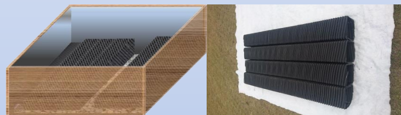
3. 碎石層上擺設4" 滲透網管及20cm 方形網管
